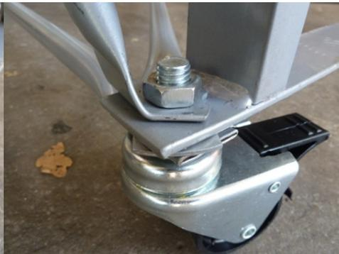
Bitte drehen Sie erst alle Muttern bei der Montage leicht auf. Erst wenn der komplette Ständer montiert ist drehen Sie alle Schrauben ganz fest. Die Stangen nehmen dann die richtige Form an und durch die Verspannungen können sich die Muttern nicht lösen. Sollte der montierte Ständer etwas wackeln, gleichen Sie bitte einen evtl. Höhenunterschied von einem Rad mit Unterlegscheiben oder der extra beiliegenden Mutter aus.
