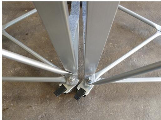
Nehmen Sie die beiden Hauptträger und setzen die gepolsterte Querverstrebung und die langen Stangen für das hintere Kreuz ein. Das hintere Kreuz kann je nach Wunsch in beide Richtungen angebracht werden. (Siehe Bild unten) Bitte die Muttern vorerst nur 3-4 Gewindegänge aufdrehen
